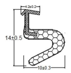
PU包覆密封条-卡槽式:KMT-M1032
