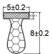
PU包覆密封条-卡槽式:KMT-C0508
