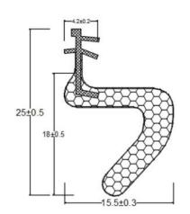
PU包覆密封条-卡槽式:KMT-M1501
