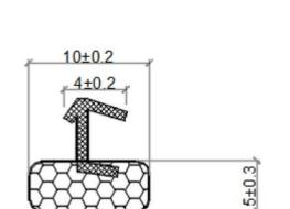
PU包覆密封条-卡槽式:KMT-M1024
